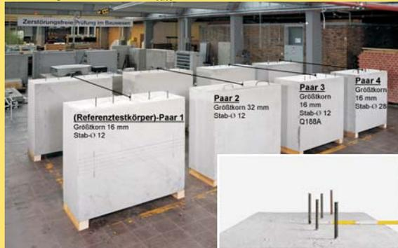
Abb. 4: vier Testkörperpaare für die Anwendung der POD(a)-Analyse am Beispiel des Impulsradarverfahrens
